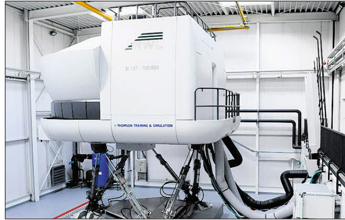
Der acht Tonnen schwere Simulator steht auf sechs hydraulischen Beinen, die sich beim simulierten Flug mitbewegen.
